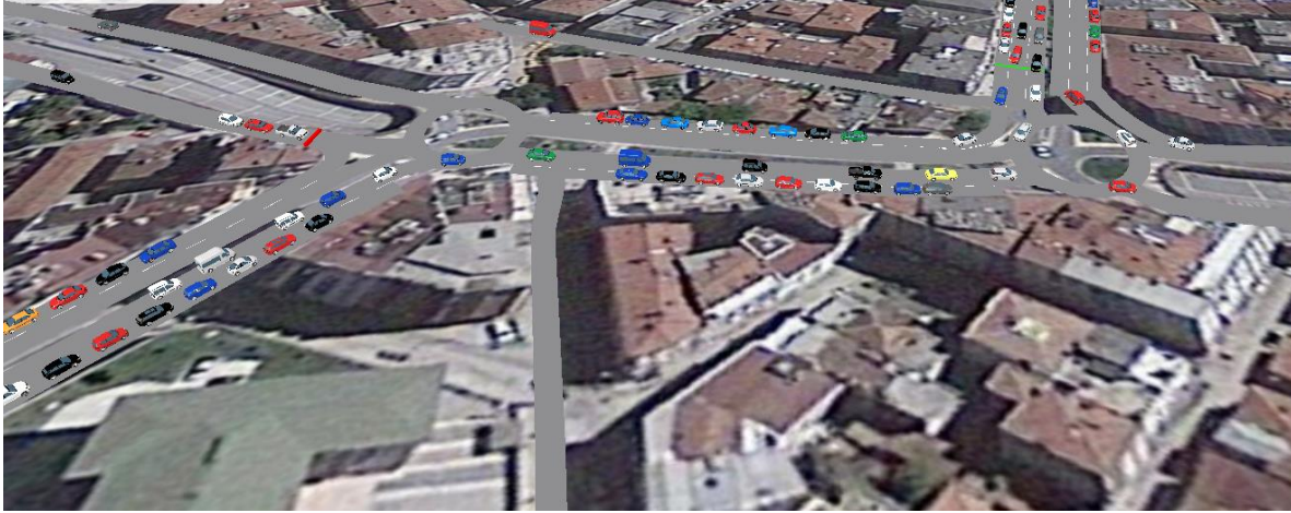
Şekil 5 Kısmi Denetimli Sinyalize Dönel Kavşağa ait VISSIM Modeli
