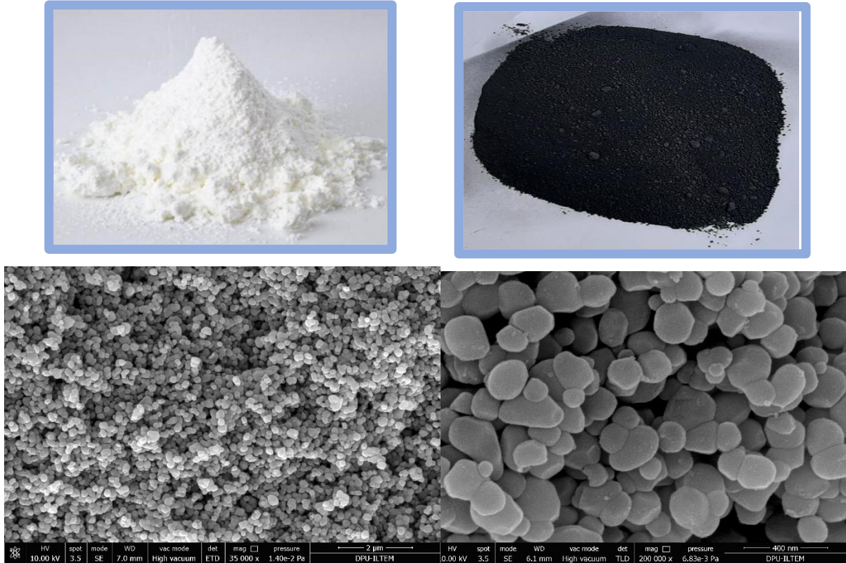
Şekil 13. (a) Kaplama öncesi TiO 2 , (b) Kaplama sonrası TiO 2
