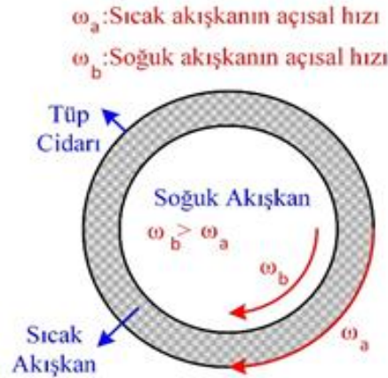
Şekil 2. RHVT içerisindeki sıcak ve soğuk akışın hareketi
