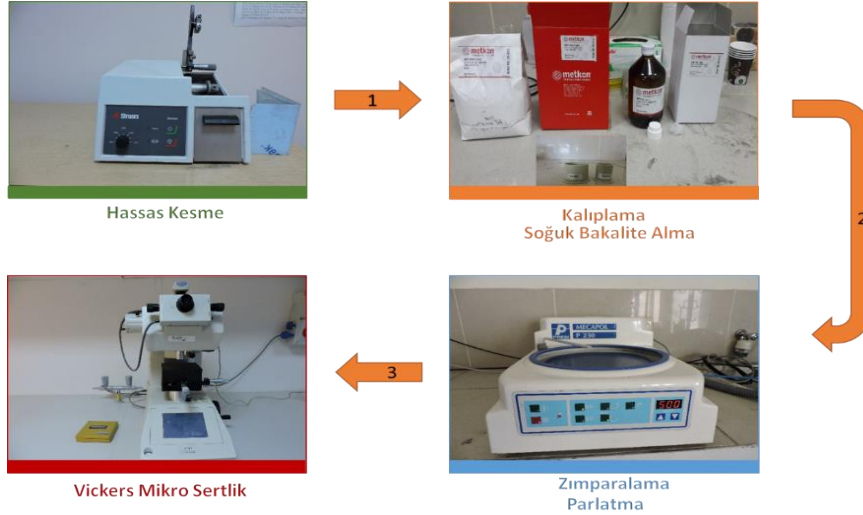
Şekil 4. Metalografik hazırlık aşamaları
