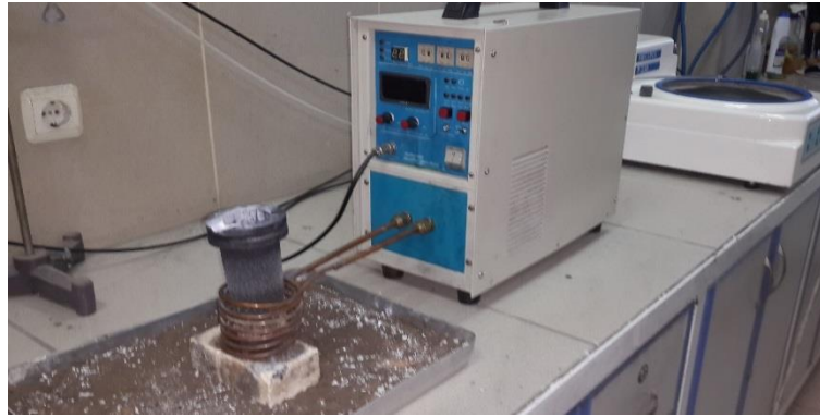
Şekil 1. Eritme işlemlerinin yapıldığı indüksiyon ısıtıcısı (Figure 1. Induction heater with melting processes)
