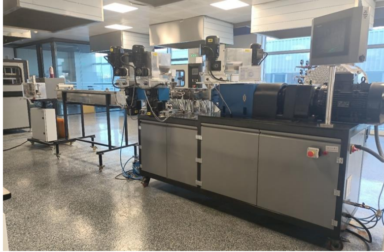
Şekil 1. Polimer karışımlarını hazırlamak için kullanılan çift vidalı ekstrüder.
